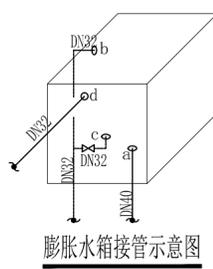
膨胀水箱接管示意图
